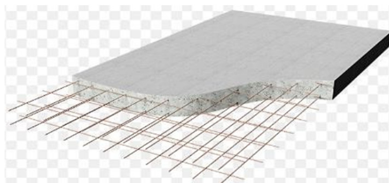
Figure I-2. Plancher à dalle pleine.
