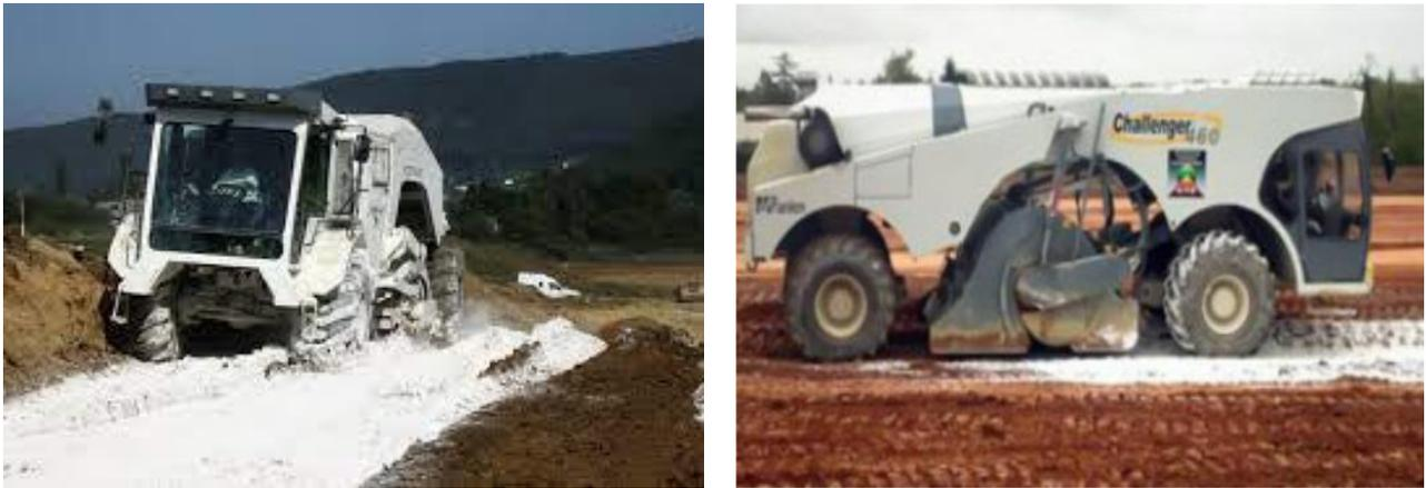
**Figure 1.9:** Chantier de traitement d'un sol à la chaux (France, 2009).
