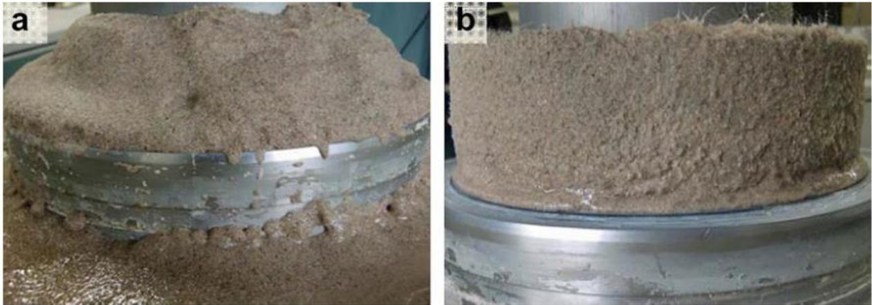
**Figure 2.32:** Deux photos des échantillons lâches entièrement liquéfiés après cisaillement:
