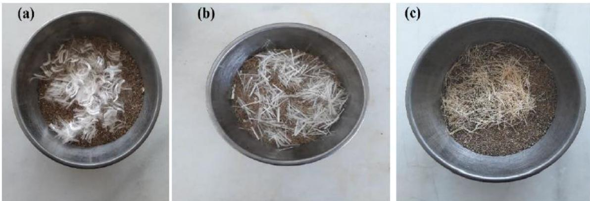
**Figure 3.8:** Mélange de sable et de fibres: (a) fibres de polypropylène; (b) fibres de verre; (c) fibres de chanvre.
