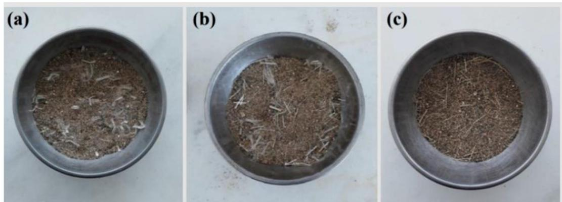
**Figure 3.9:** Échantillons renforcés par fibres: (a) fibres de polypropylène; (b) fibres de verre; (c) fibres de chanvre
