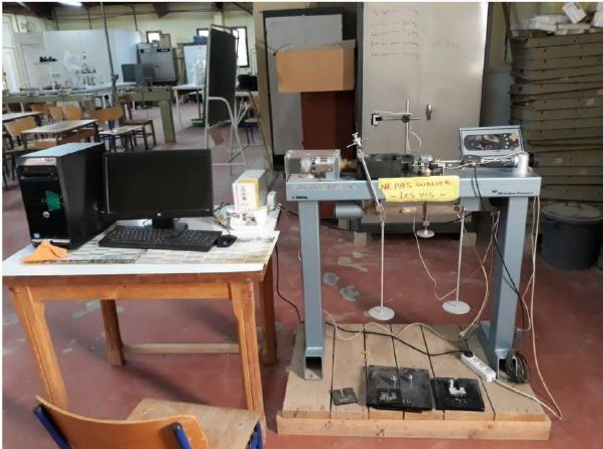
**Figure 3.3:** Boîte de cisaillement direct utilisée
