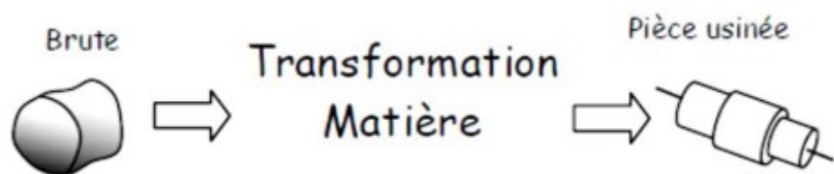
Figure 23 : Principe de l'usinage.
