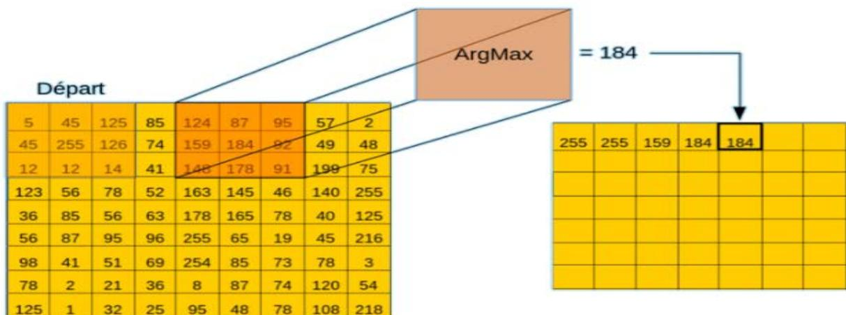
Figure 4: Exemple de La couche de MaxPooling [8].
