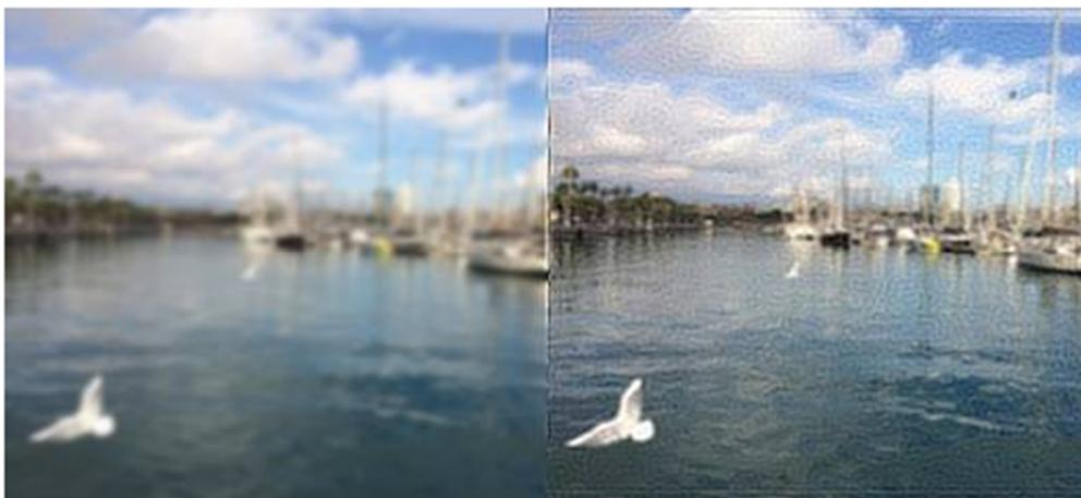
**Figure 45:** Résultats du logiciel de filtrage Wiener - Flou gaussien
