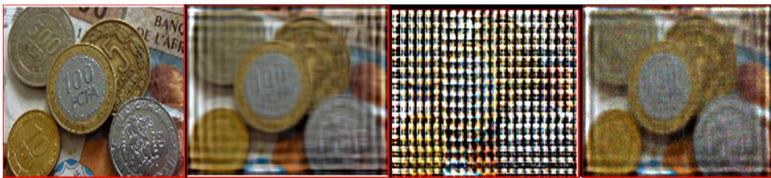
(a)Image original (b) image Wiener filtre (c)image régularisée (d) Richardson-Lucy
