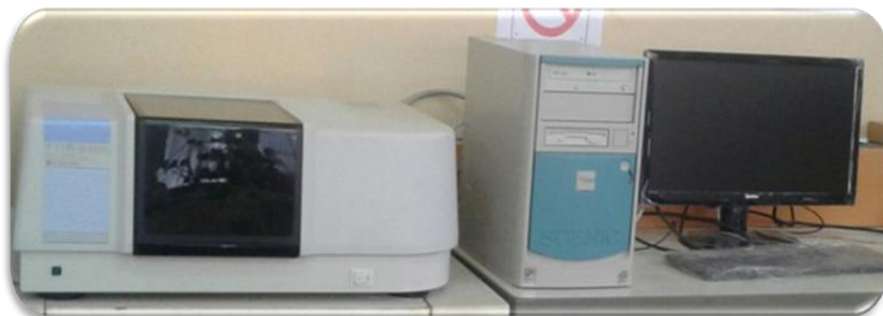
Figure.III.21 : Spectromètre infrarouge à transformée de Fourier (FTIR)
