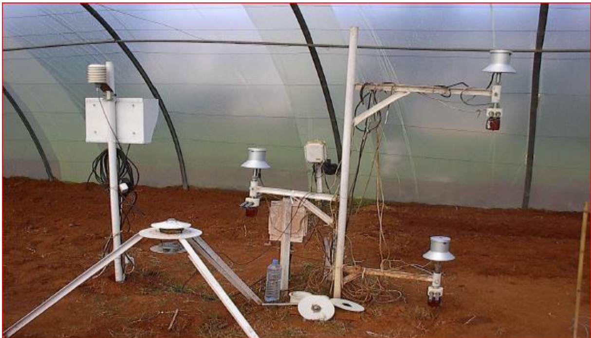
Figure. III.4 : Centrale automatique de mesure de température et d'humidité.
