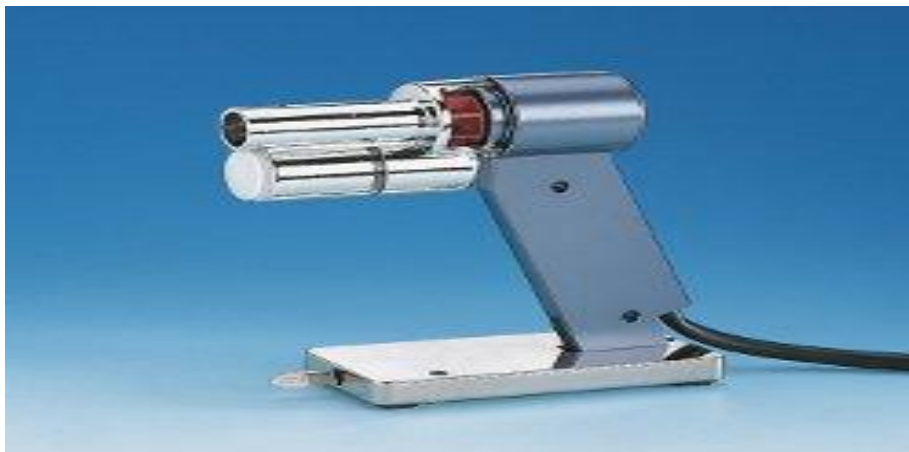
Figure. III.6: Psychromètre à ventilation forcée .
