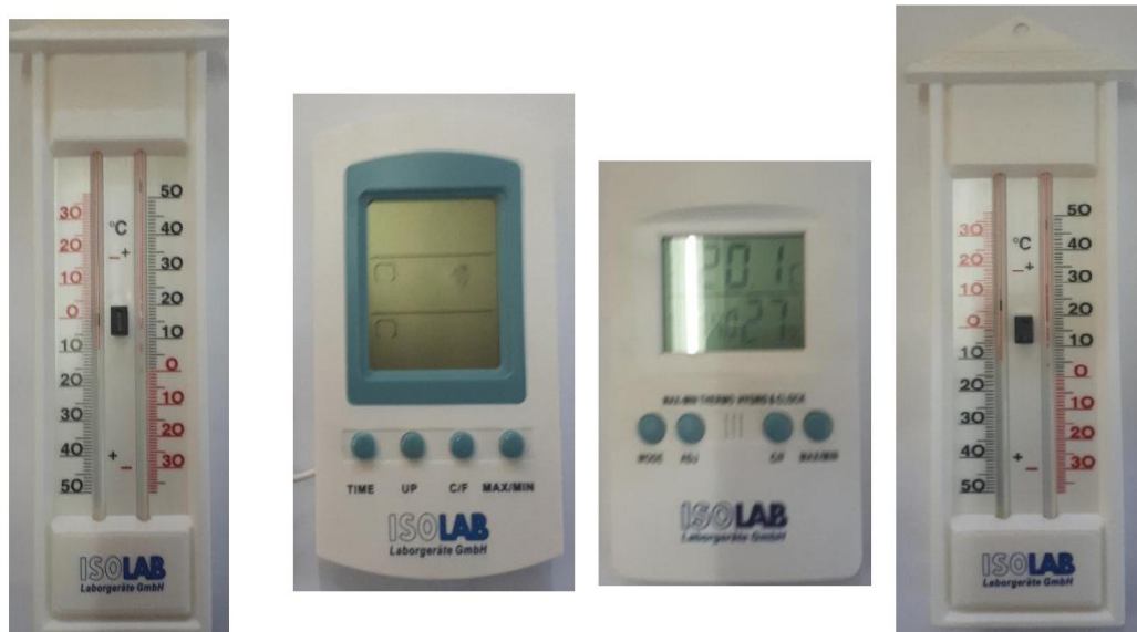
Figures III.8: Instruments de mesure de l'humidité et de la température
