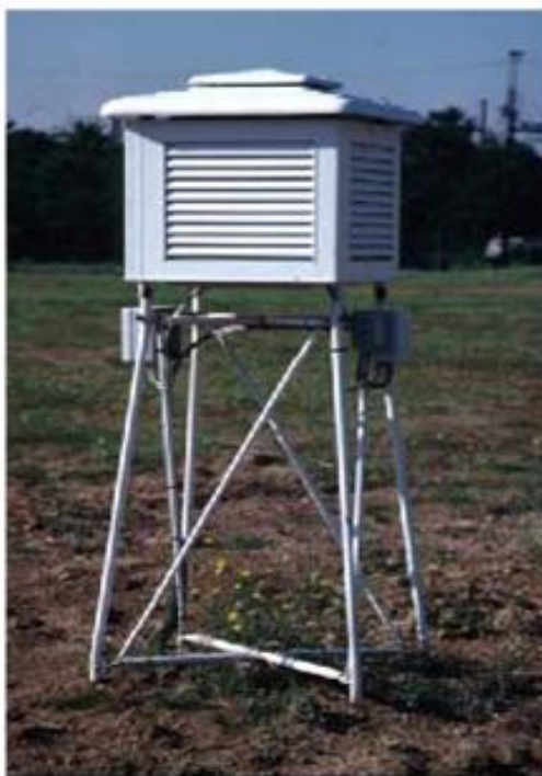
Figure.III.7 : Abri météorologique équipé.
