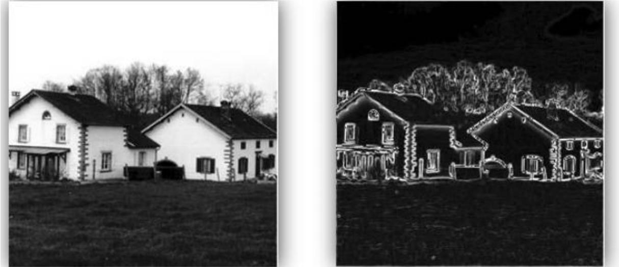
Figure 7 : Détection des contours d'une image par convolution de type Sobel.
