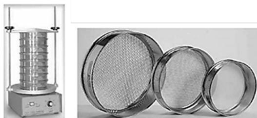
**Figure IV.1 :** Essai analyse granulométrique.
