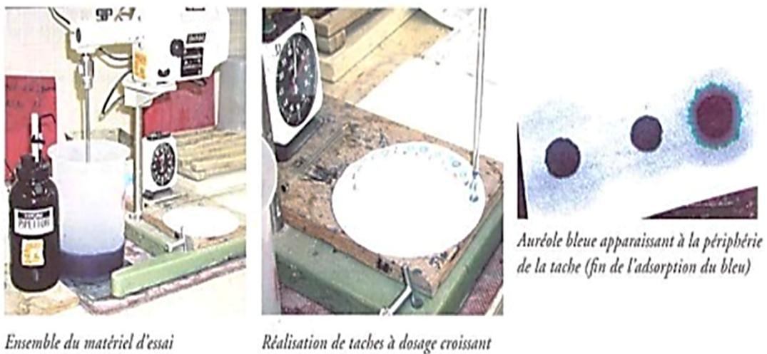
Figure IV.4 : Essai au bleu de méthylène.
