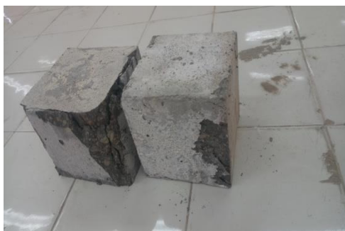
Figure III.26 Mode de rupture des éprouvettes après écrasement
