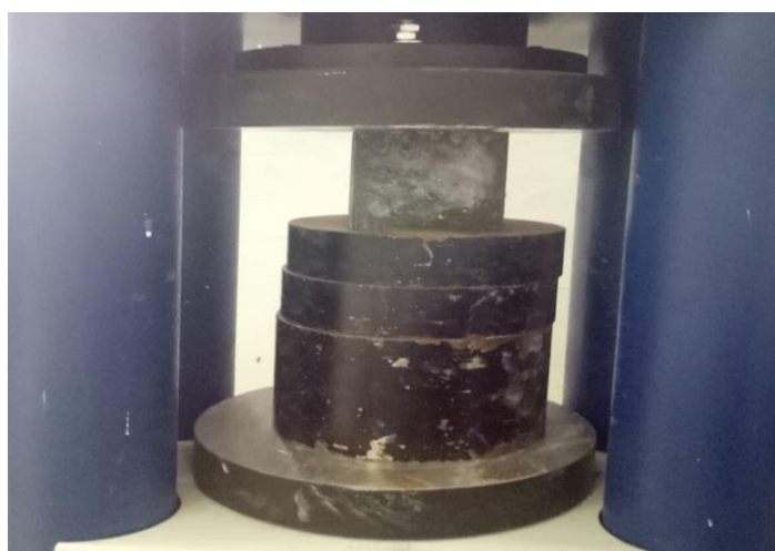
Figure III.25 Chargement des éprouvettes cylindriques et cubiques pour l'essai décompression
