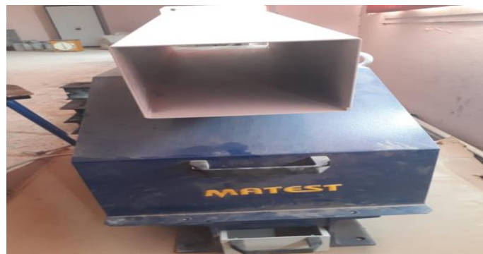
Figure III.2 Concasseur, préparation des granulats recyclés
