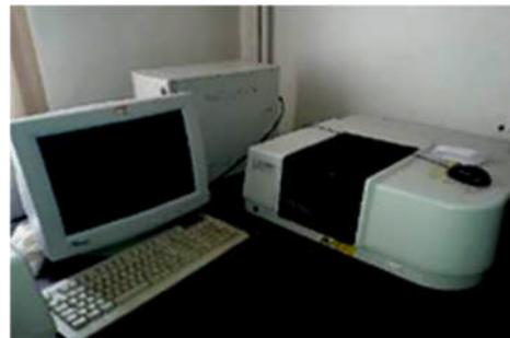
**Figure III.2 :** Schéma général d'un spectromètre IR à transformée de Fourier (à gauche), photo du Spectromètre IRTF 8300(à droite)
