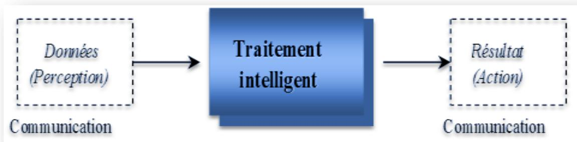
**Figure III. 2:** Architecture minimale d'un agent.
