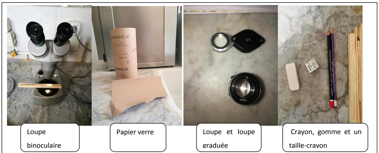
**Fig.11.** Matériels de préparation et de mesure des échantillons. (Bettetal et Boukhadia, 2020)
