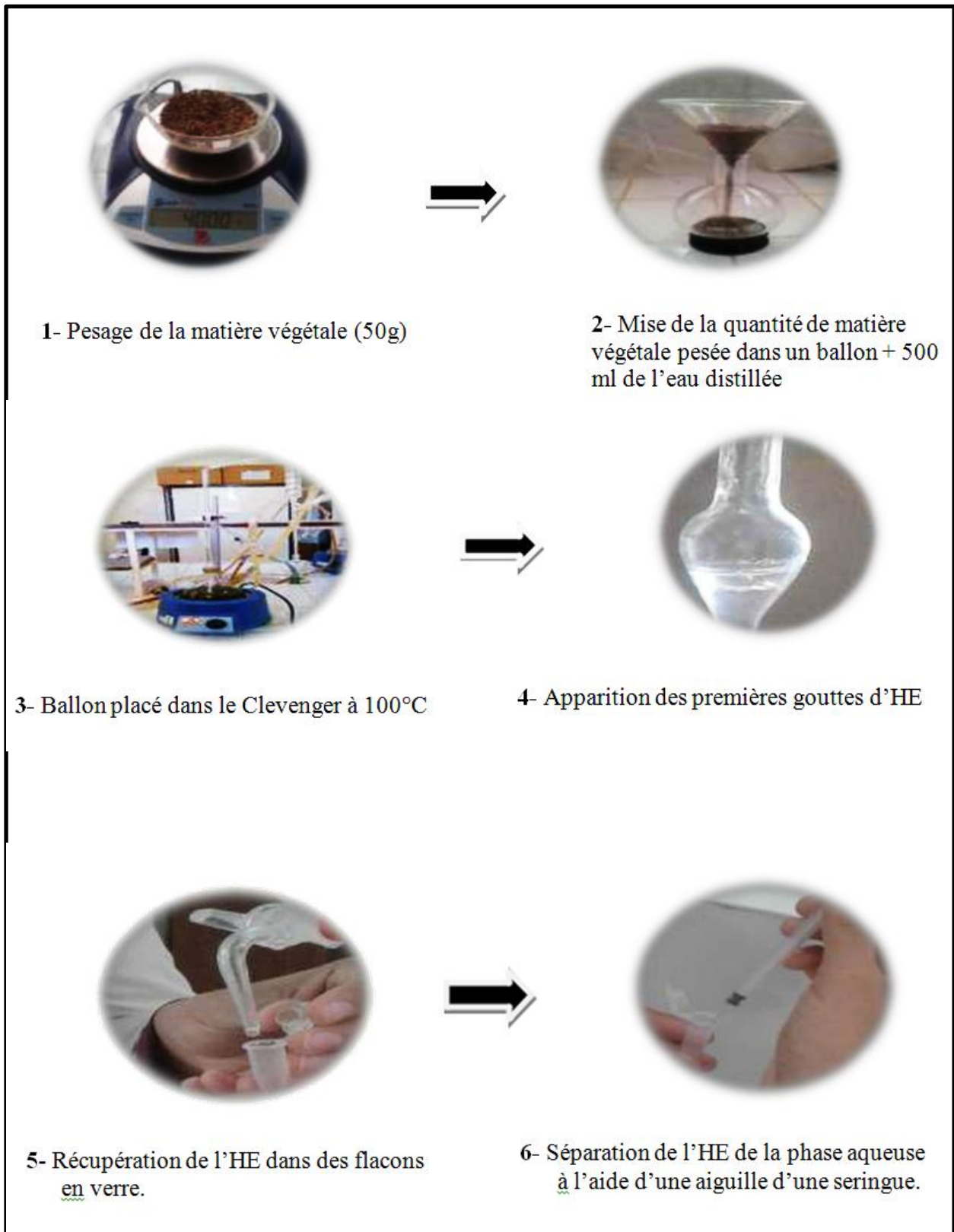
Figure 26 : Etapes de l'extraction des huiles essentielles par hydrodistillateur de type Clevenger (Originale, 2020)
