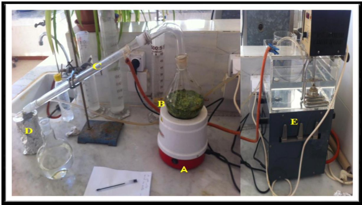
Figure17 : Montage d'hydrodistillation employé pour l'extraction d'huile essentielle: Clévenger ( Originale, 2020 )
