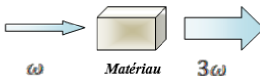
Figure.III.6 : Principe de la génération de troisième harmonique.
