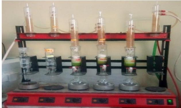
**Figure 9** : Dispositif du Soxhlet utilisé pour l'extraction des huiles végétales.
