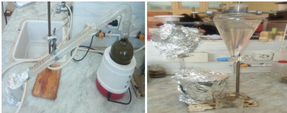
**Figure 8:** Dispositif utilisé pour l'extraction de l'huile essentielle de *Rosmarinus officinalis* L.
