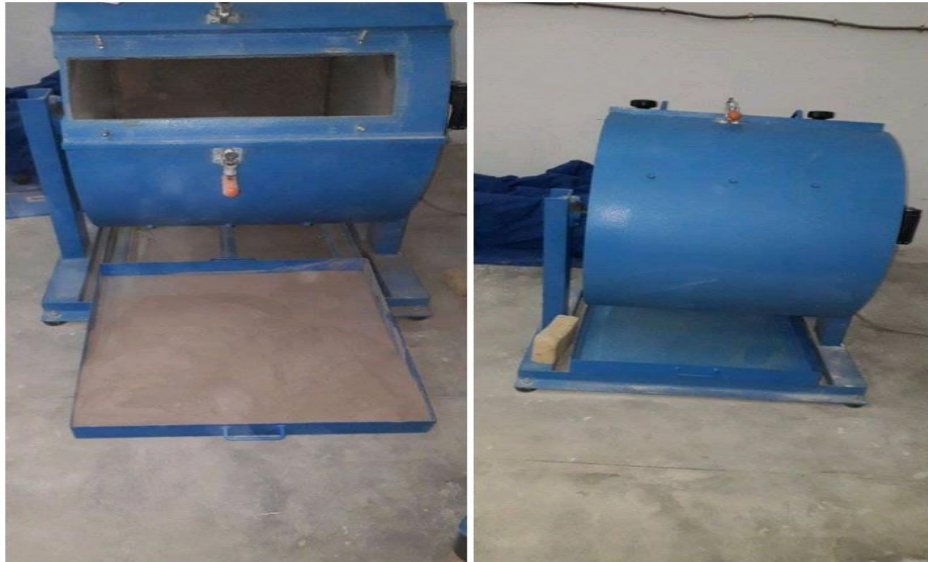
Figure 3.7. Broyage et préparation de la pouzzolane.
