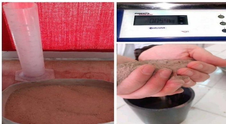
Figure 3.3. Matériel pour déterminer la masse volumique
