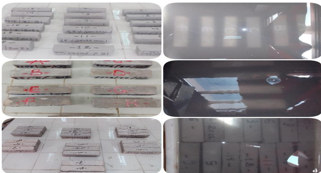
Figure 4. 6. Démoulage et conservation des éprouvettes dans l'eau.
