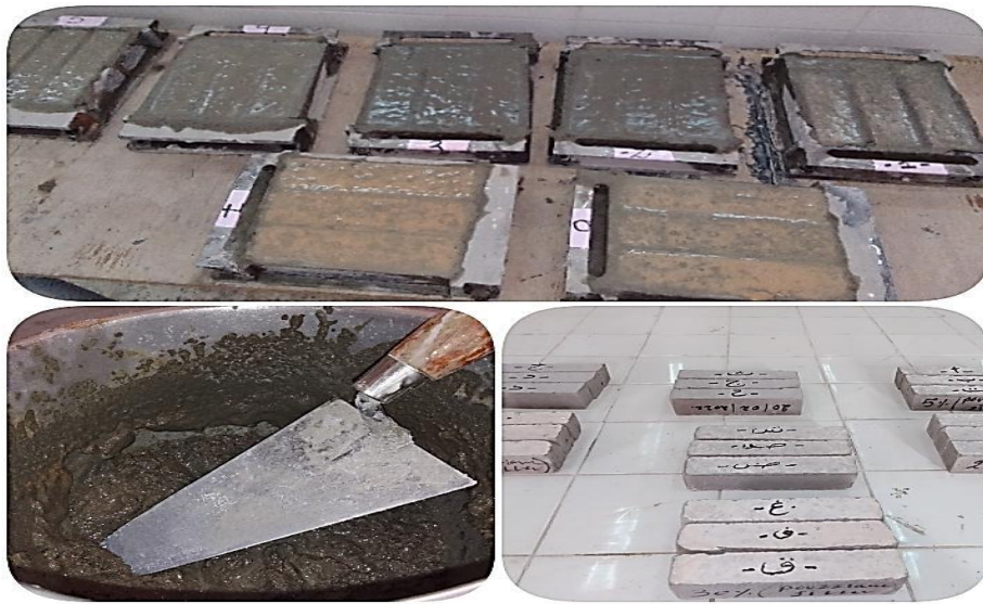
Figure 4. 3. Malaxage et préparation des moules.
