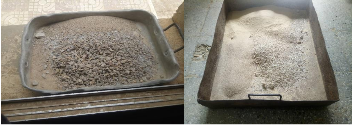
Figure V.1 : préparation du mélange (GNT+ verre) pour les deux formes angulaire et arrondie.
