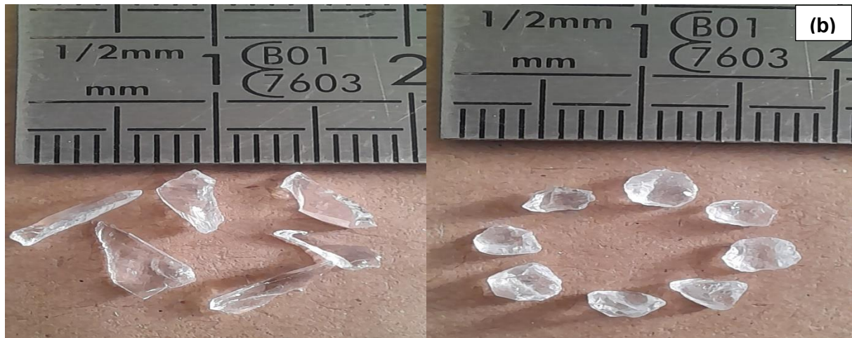
Figure IV.2 : Particules de verre après broyage : (b) Forme Arrondie ; (a) Forme angulaire
