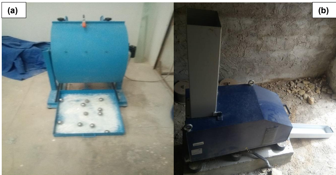
Figure IV.1 : Appareillage de Broyage des déchets de verre : (a) avec l'appareil Los Angeles ; (b) concasseur de laboratoire
