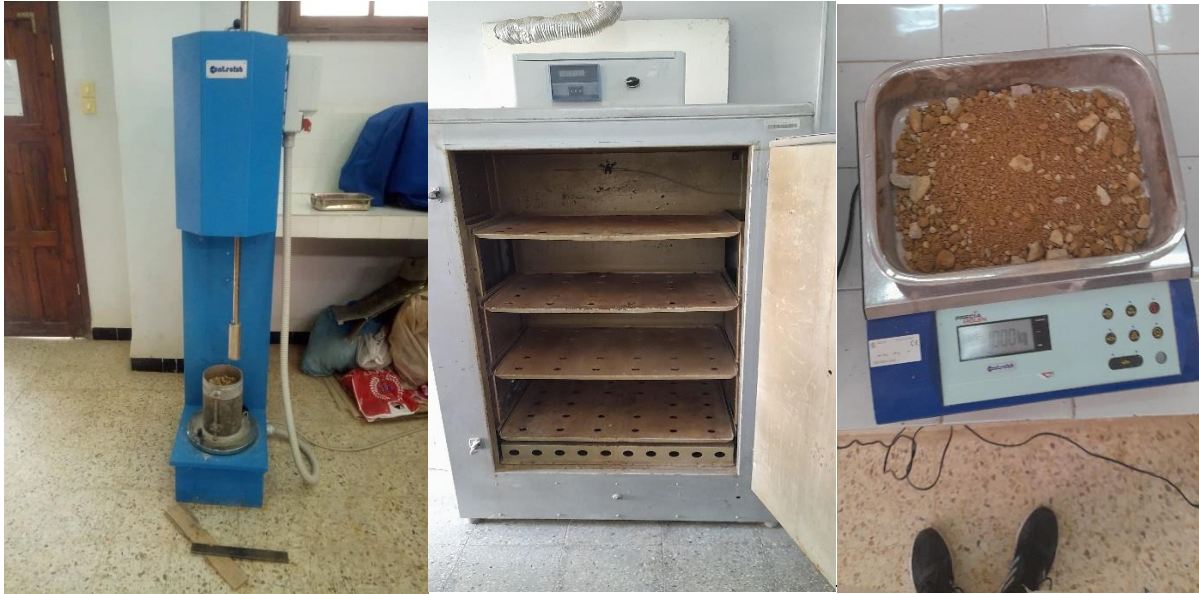
Figure V.4: Matériel utilisés pour l'essai Proctor.
