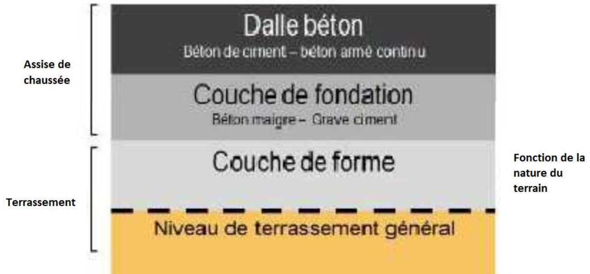
Figure I.5. Construction d'une chaussée en béton de ciment.
