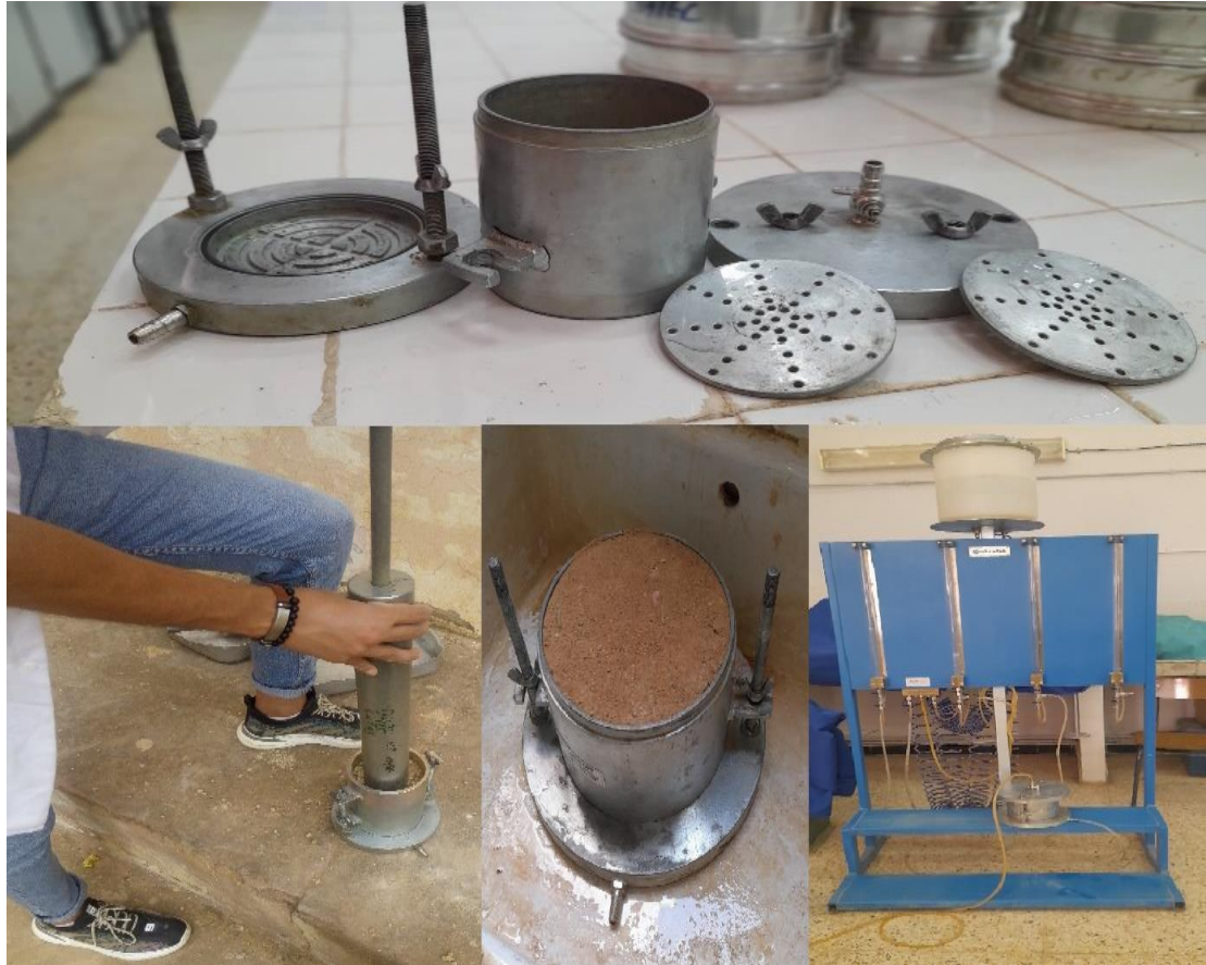
Figure V.20 : l'exécution et l'appareillage d'essai de perméabilité.
