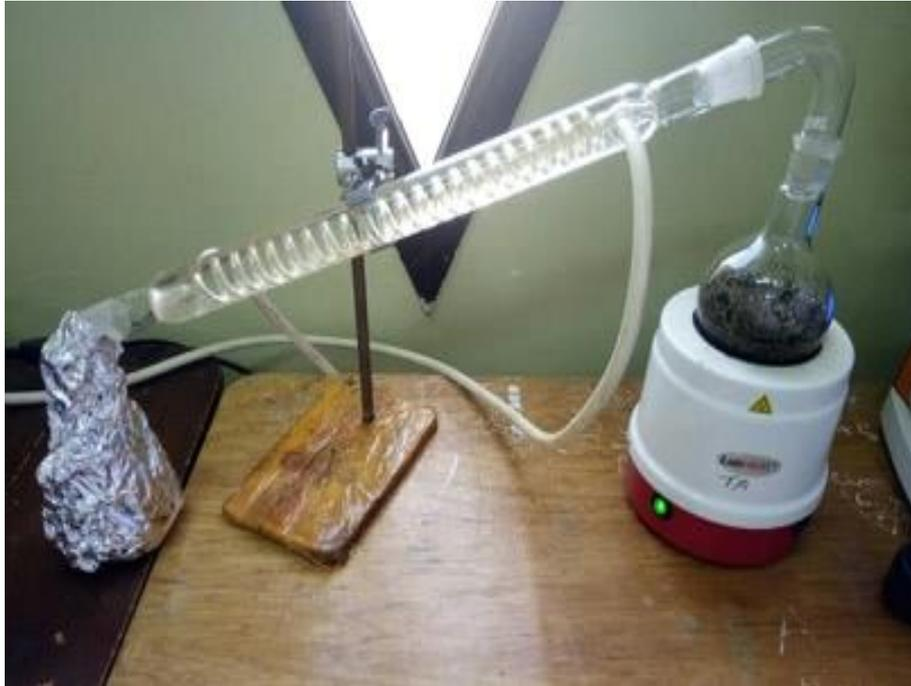
**Figure n°15** : Dispositif d'hydrodistillation
