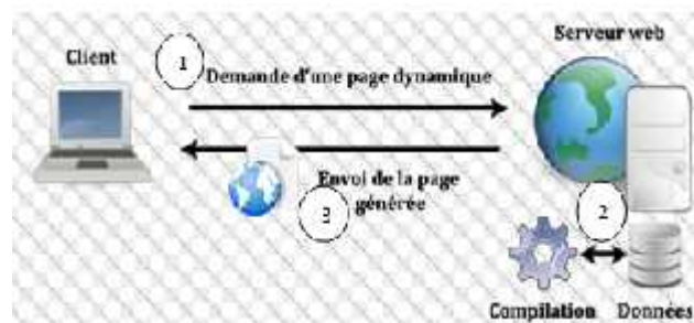
Figure I.6 : Architecture d'un site dynamique
