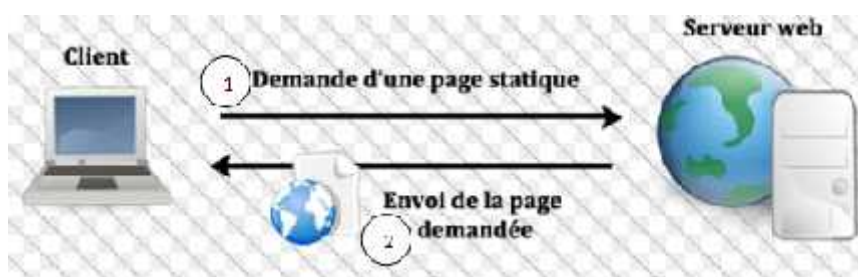
Figure I.5 : Architecture d'un site statique
