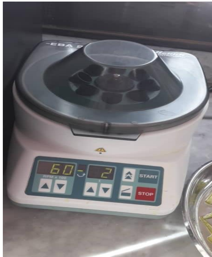
Figure N°22 : centrifugeuse de laboratoire.
