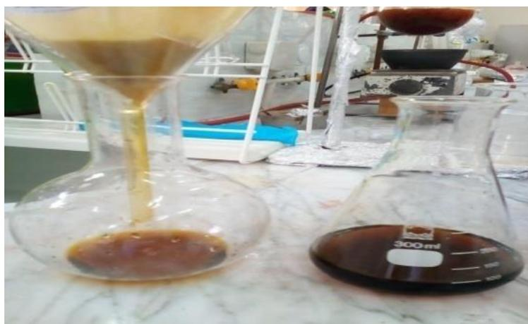
**Figure 10** : Filtration et obtention d'un filtrat rouge
