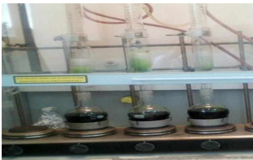
**Figure 13 :** Dispositif du Soxhlet utilisé pour l'extraction.
