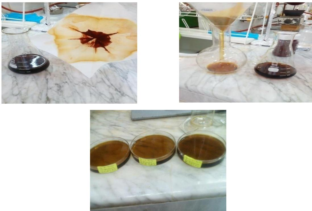
**Figure 11** : Les filtrations successives et l'évaporation du filtrat final
