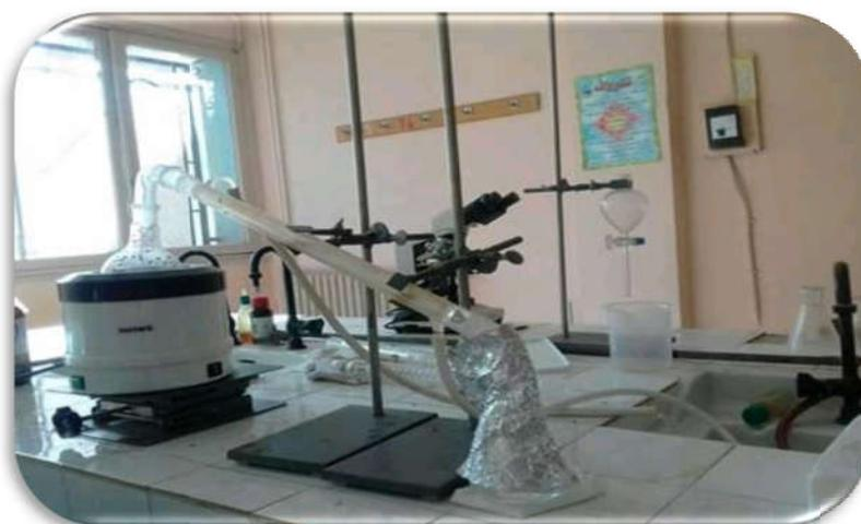
**Figure5.**L'appareil utilisé pour l'extraction de l'huile essentielle par hydrodistillation.
