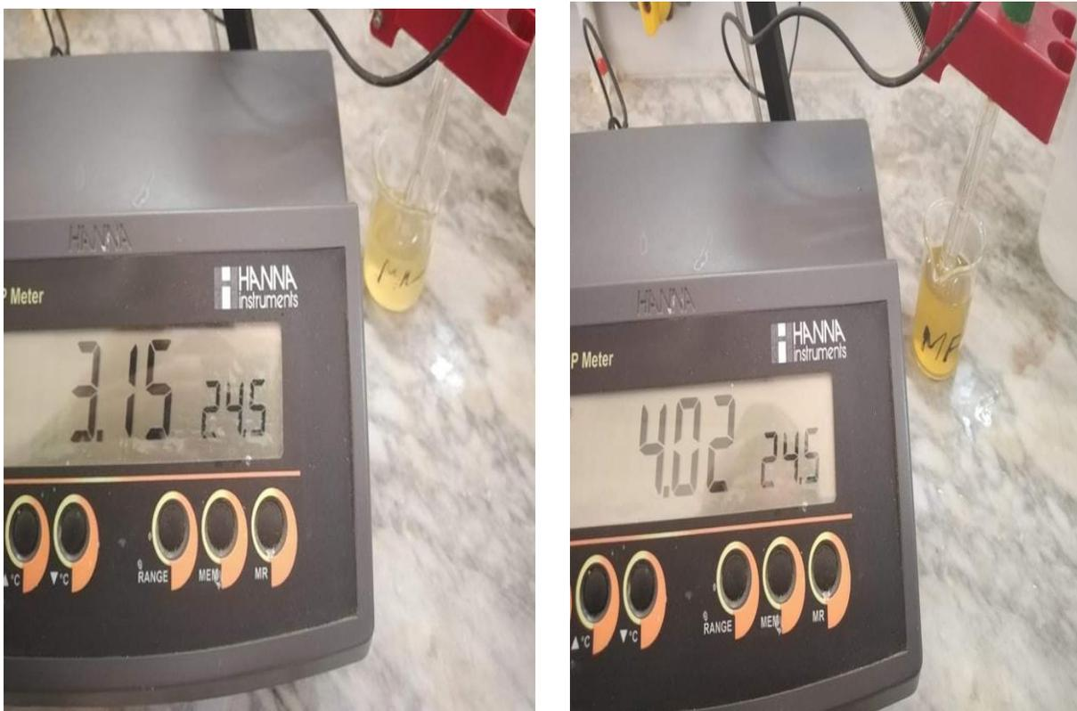
**Figure 02** : mesure le pH du miel fermenté et miel normal avec pH mètre .
