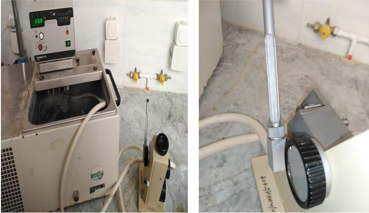
**Figure 03** : détermination de l'indice de réfraction du miel fermenté et miel normal.
