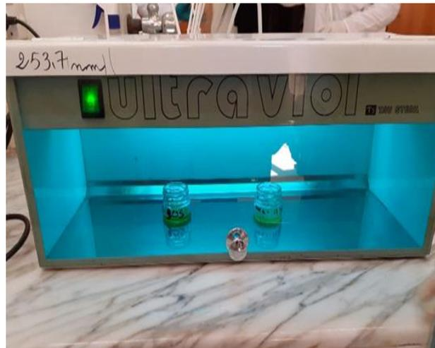
**Figure 5:** exposition de miel au l'appareil d'ultraviolet ( $\lambda=253,7\text{nm}$ ).
