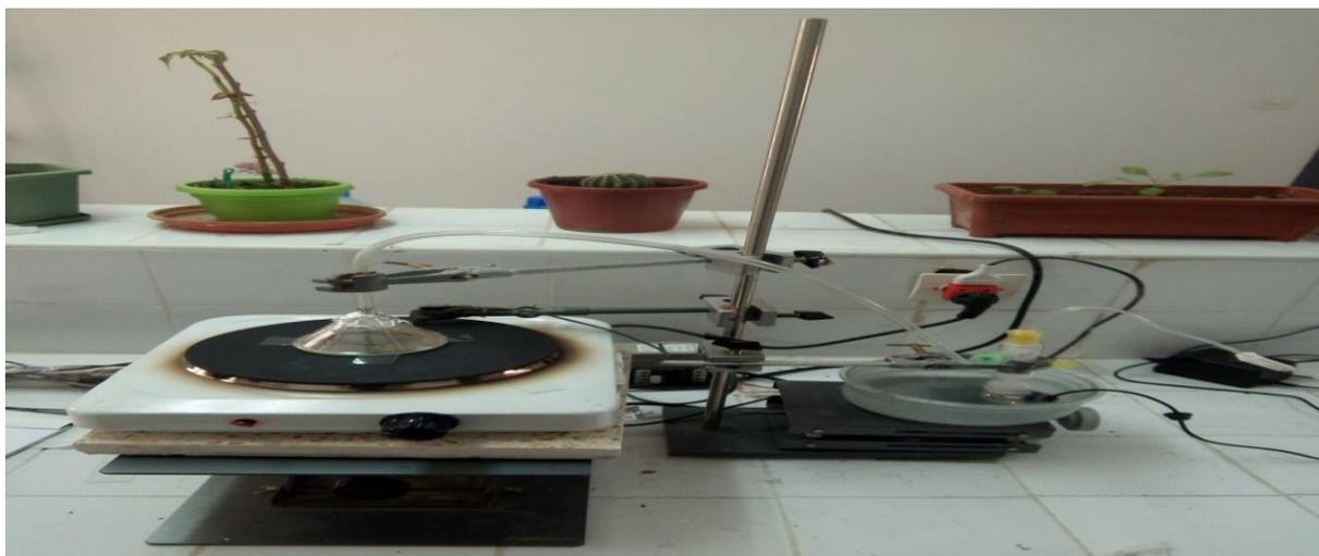
**Figure III.6 Bâti du spray pyrolyse ultrasonique**
