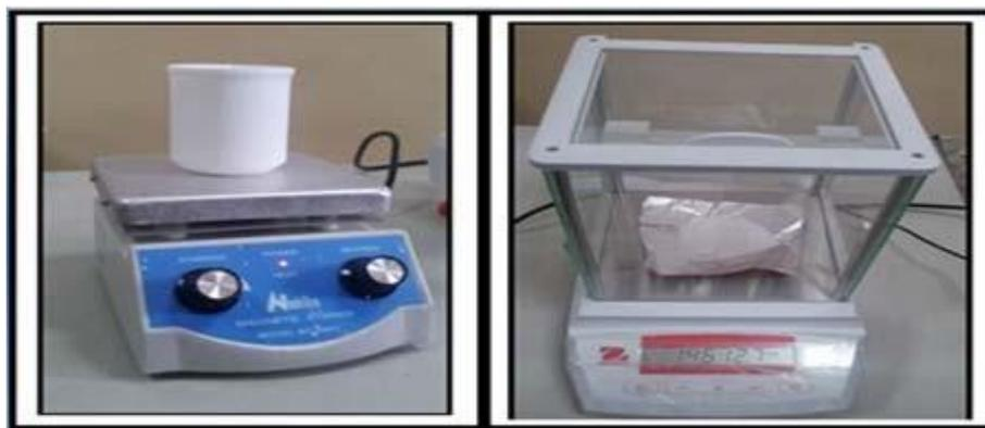
*Figure II.9. Agitateur et balance.*
