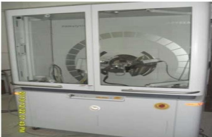
Figure IV.2 Photographique du diffractomètre : « Panalytical ».
