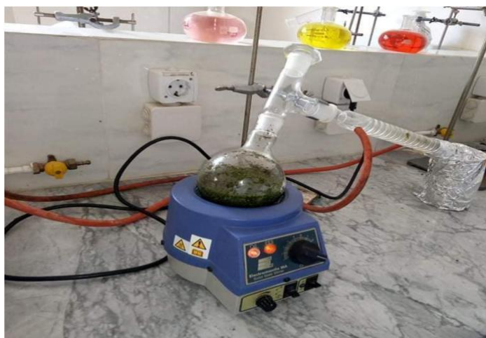
Figure n° 10 : Appareillage d'hydrodistillation au niveau de laboratoire.
