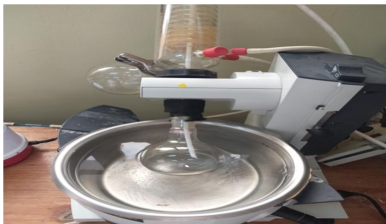
Figure n° 07 : Elimination du solvant par évaporateur rotatif.
