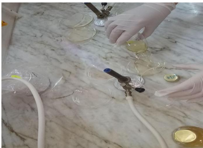
Figure n° 11 : Coulage des boîtes de Pétri par le milieu de culture PDA.
