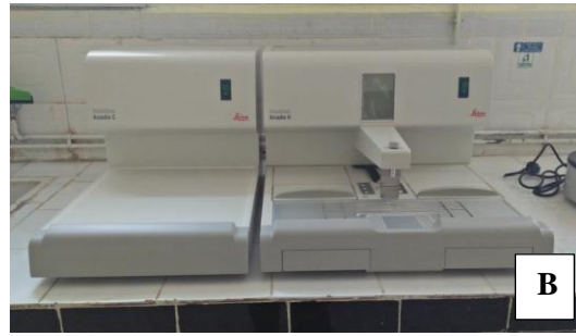
Centrale d'enrobage LEICA Arcadia C 2615 et Arcadia H 2224.
