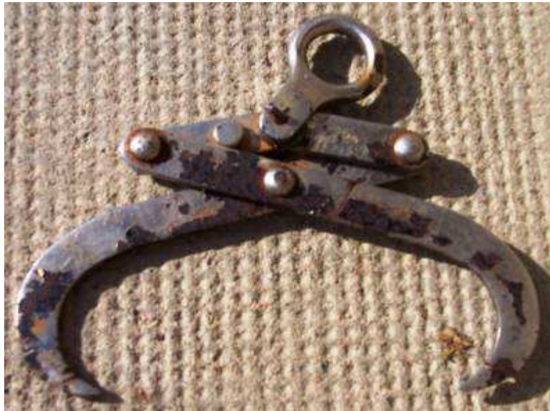
Photo 52 : Crochet de Huynen fermé
