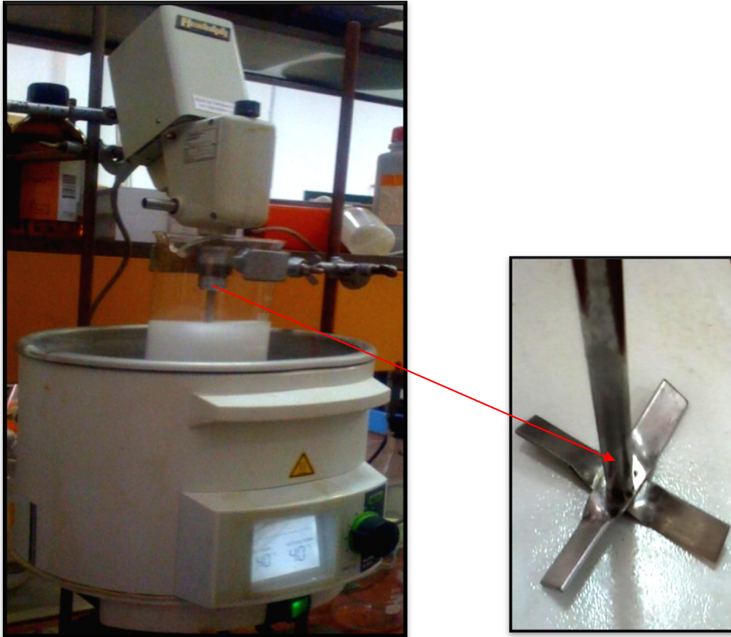
Figure 5: Dispositif expérimental de la synthèse des microsphères.
