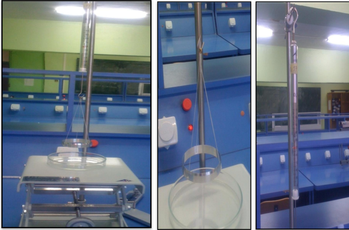
Figure 2: Dynamomètre dispositif de calcul de la tension superficielle
