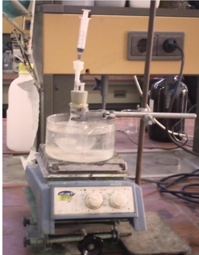
Figure 8 : le dispositif expérimental de la libération du PA.
