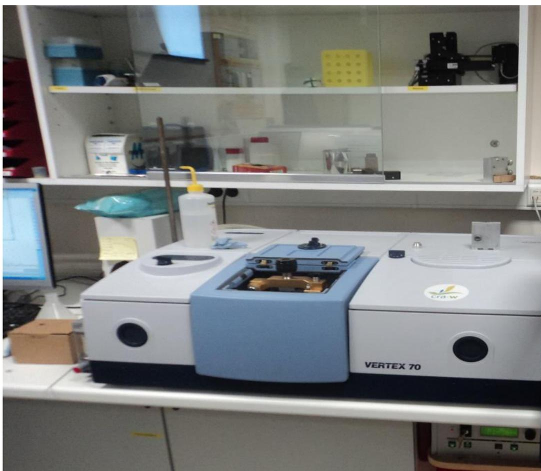
**Fig.III.12.** Un spectromètre FTIR/ATR Vertex70-RAM II Bruker (Bruker analytique, Madison, WI)
