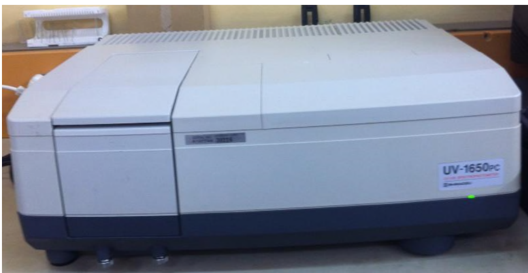
Figure V-3 : Spectrophotomètre UV-Visible de marque SHIMADZU UV-1650-PC à double faisceaux.
