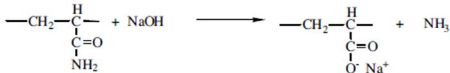
Figure8 : Hydrolyse basique du polyacrylamide.
