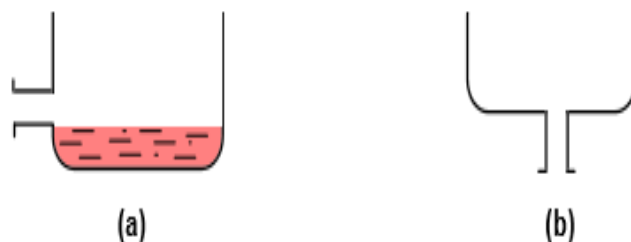
Figure II.1: Prévention par la forme du récipient. (a) : mauvais. (b) : correct
