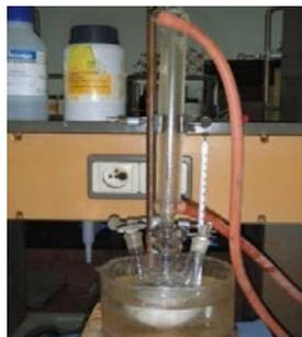
**Figure IV.3 : Montage à reflux**
