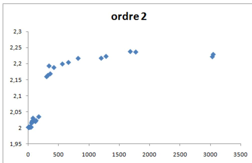
**Figure :**  $1/(m_i^0 - m_t) - 1/m_i^0$  en fonction du temps (disque EC+AMP)
