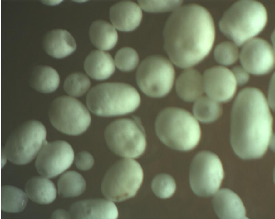
**Figure 12** : Observation des microsphères 2 (à base d'HPMC) par microscope optique (X200).
