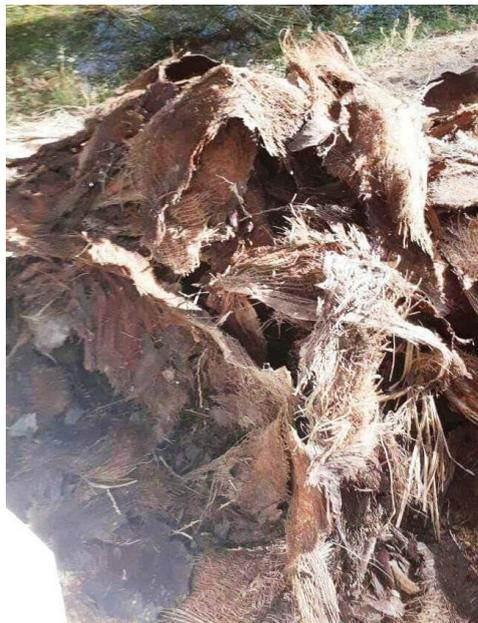
**Figure 22** : fibre de palmier dattier utilisé
