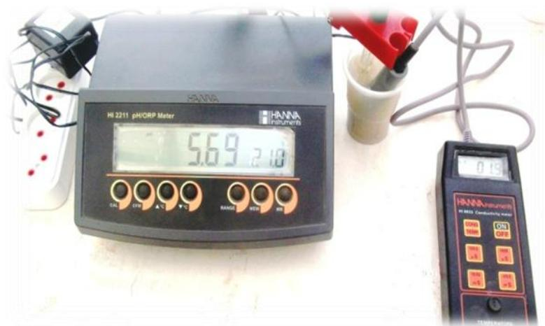
**Figure 23** : pH mètre et conductimètre utilisés dans la serre
