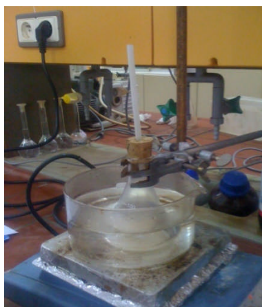
Figure II-3 : montage de préparation de l'aspirine
