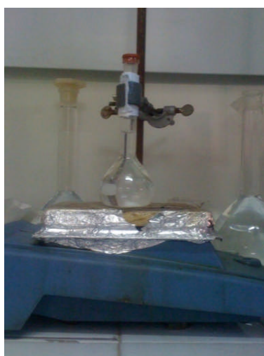
Figure II-28 : montage expérimentale pour déterminer le taux de l'encapsulation
