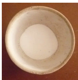
Figure I.3: Le changement de couleur de PVC poudre blanche pendant le chauffe
