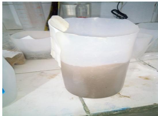
**Photo 7: la dispersion avec le pyrophosphate du sodium**
