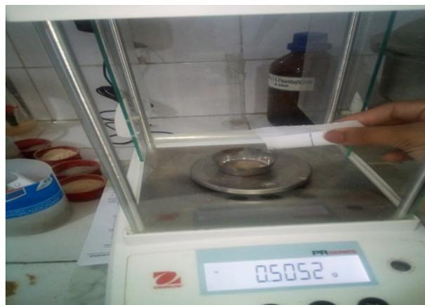
**Photo 8 : mesure du sol pour le dosage de calcaire total**
