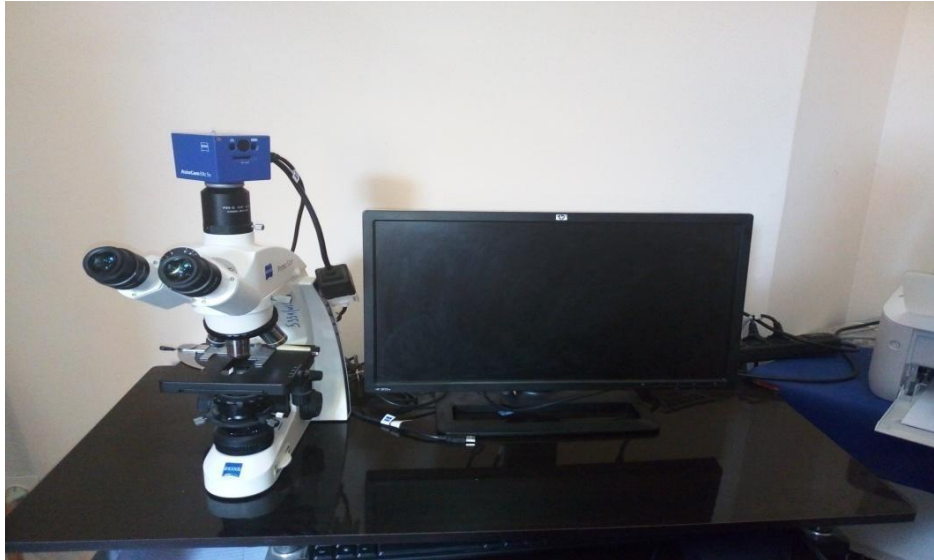
Figure 10. Microscope lié avec camera de type Primo Star
