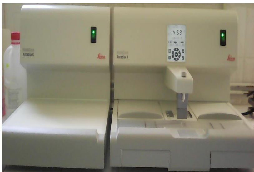
Figure 07. Station d'enrobage de type Leica.
