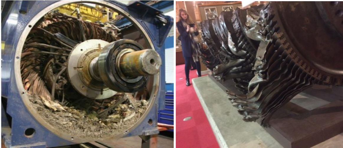
Figure I.1: Exemple des rotors endommagés [2], [3].
