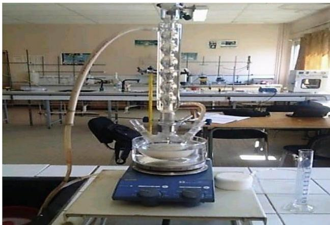
**Figure 22:** Montage de la réaction de modification de la composite bentonite sodique-chitosane par l'épichlorhydrine.
