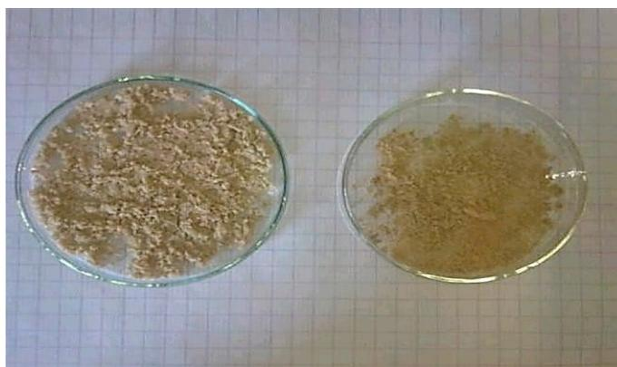
**Figure 23:** Composite bentonite sodique-chitosane modifié par l'épichlorhydrine après lavage.
