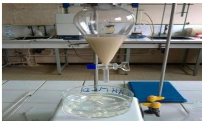
**Figure 19 :** Système de précipitation du composite obtenu dans la solution de soude.
