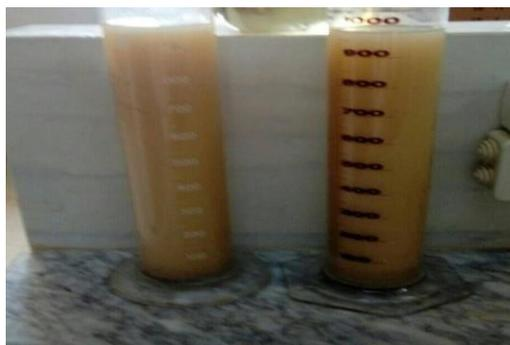
**Figure 11:** Récupération de la bentonite en suspension. Photo original.
