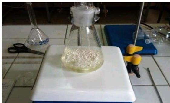
**Figure 18:** Mélange de chitosane et bentonite sodique dans l'acide acétique.
