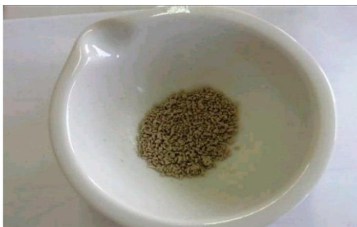
**Figure 24:** Composite bentonite sodique-chitosane modifié par l'épichlorhydrine après séchage.
