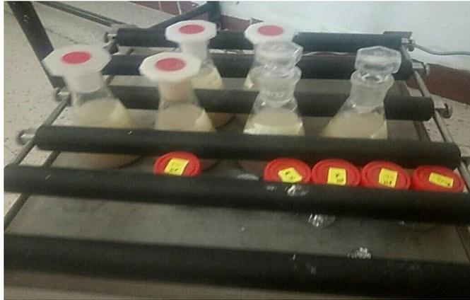
**Figure 12:** Décarbonations minéral par HCl. Photo original.
