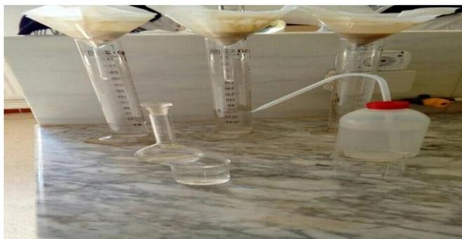
**Figure 14:** Lavage par l'eau distillée. Photo original.
