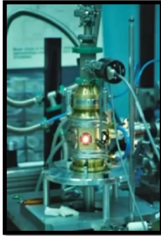
Figure I.17: Schéma de l'appareillage d'ablation laser.
