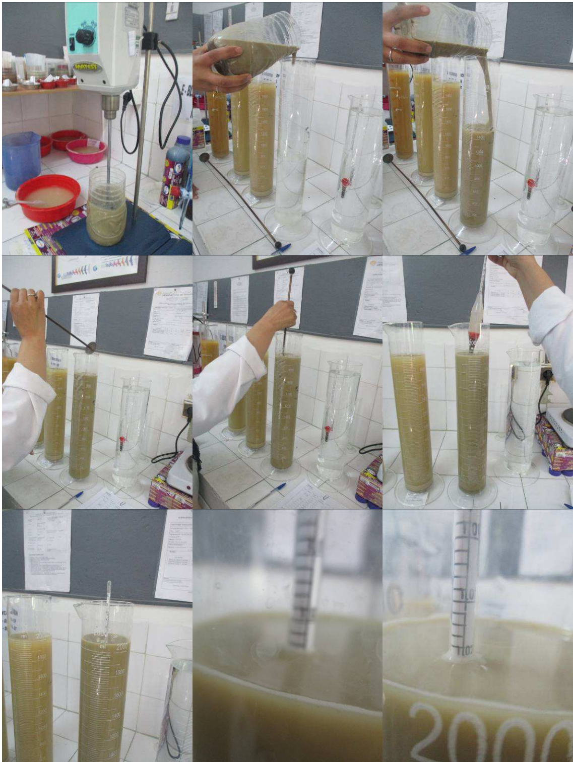
Figure 3.4: Mode opératoire l'essai analyse granulométrique par sédimentométrie.
