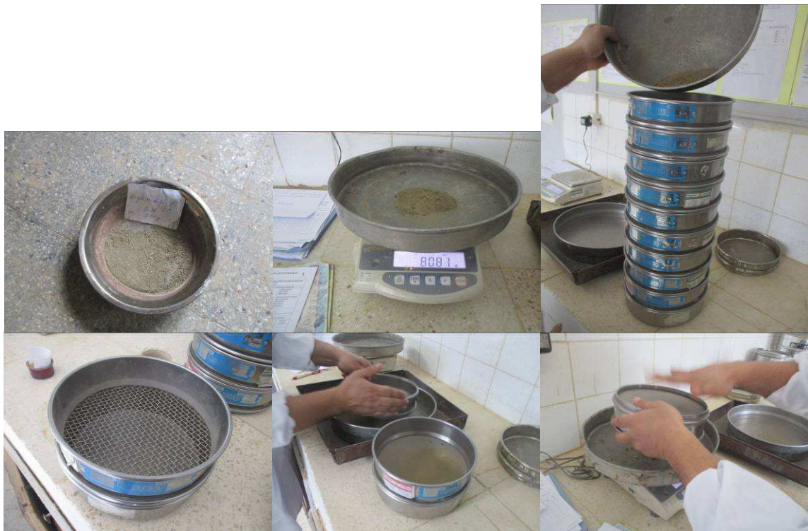
Figure 3.2: Mode opératoire l'essai analyse granulométrique par tamisage à sec
