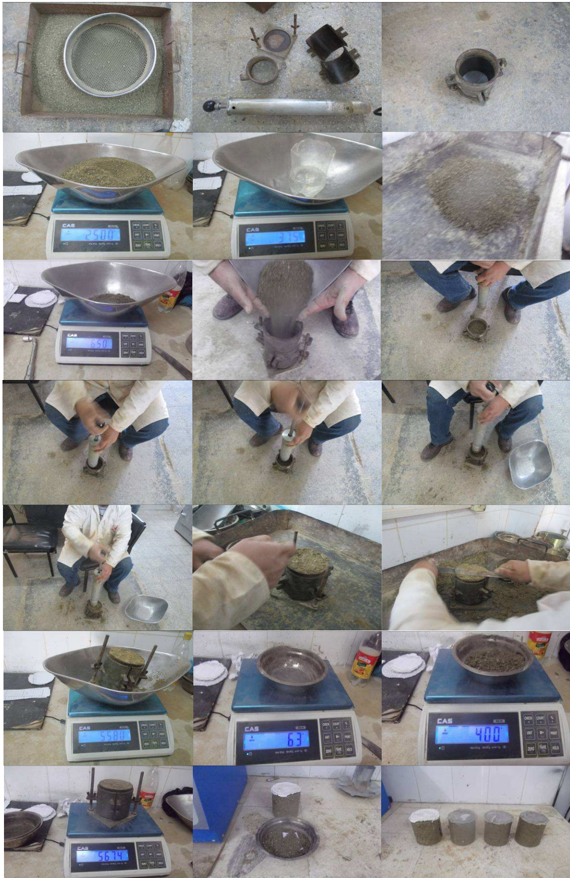
Figure 3.17: Mode opératoire d'essai Proctor
