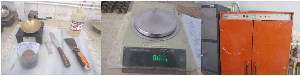
Figure 3.6: Matériel pour détermination de la limite de liquidité et la limite de plasticité
