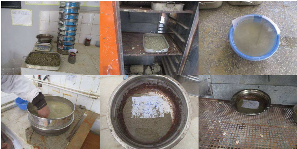
Figure 3.1: Préparation des échantillons
