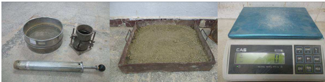
Figure 3.16: Appareillage pour l'essai Proctor
