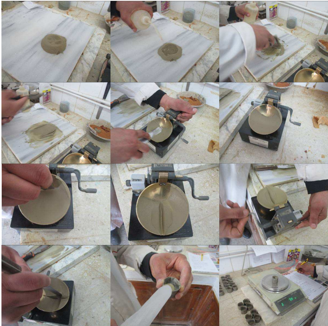
Figure 3.7: Mode opératoire pour détermination de la limite de liquidité
