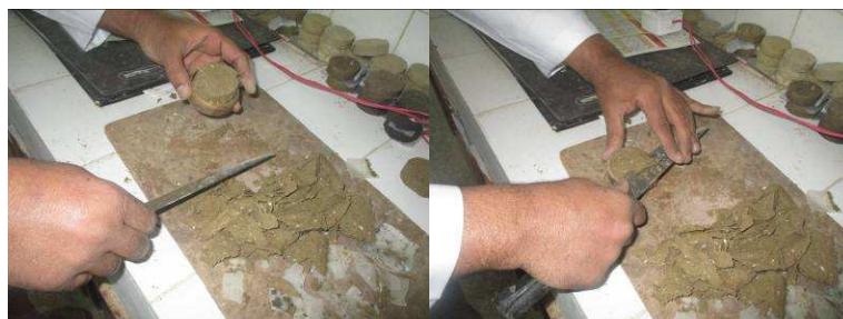
Figure 3.25: Préparation de l'échantillon (section circulaire \phi = 60\text{mm} )
