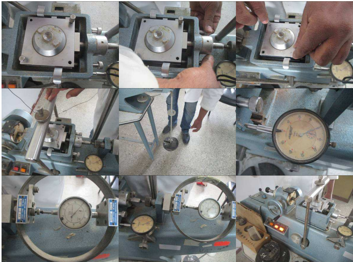
Figure 3.28: Mise en place de la boîte et réglage des comparateurs
