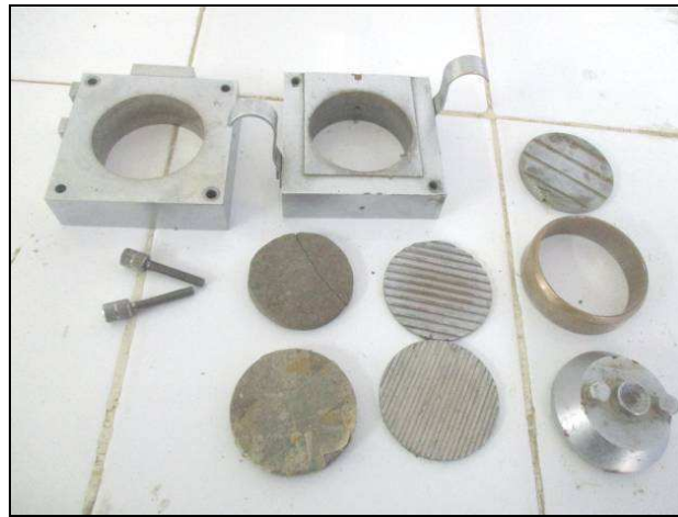
Figure 3.23: Boîtes de cisaillement avec accessoires (section circulaire, \phi = 6\text{cm} )
