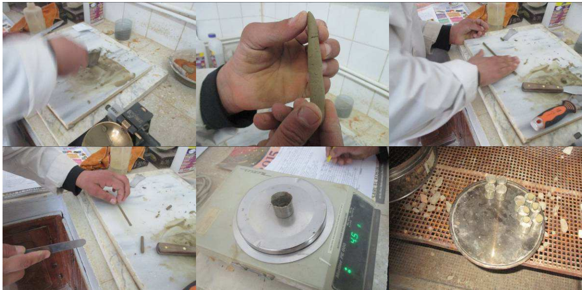
Figure 3.8: Mode opératoire pour détermination de la limite de plasticité
