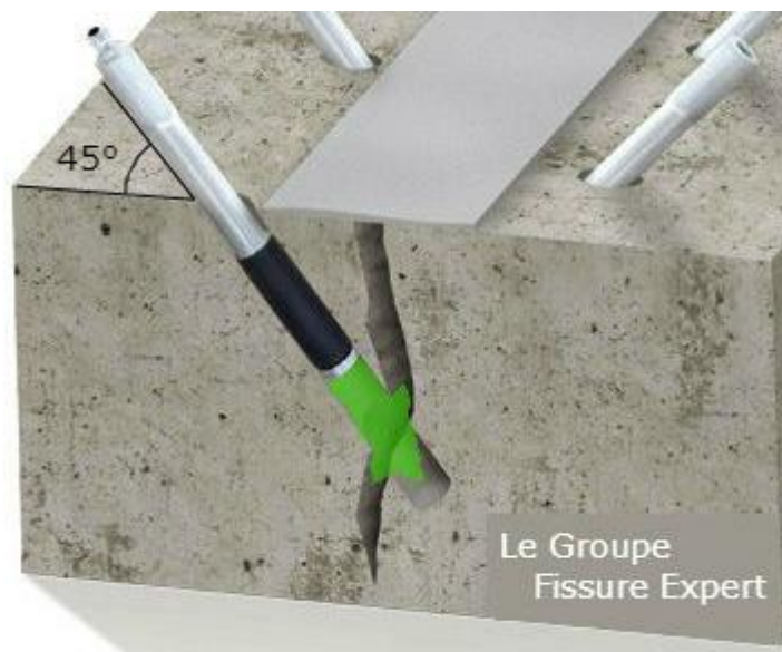
Figure II. 2 : Représentation de l'injection des fissures à haute pression.
