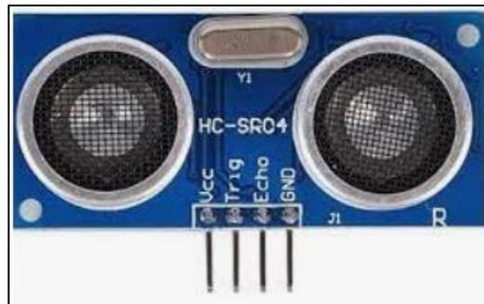
Figure III.21 : Capteurs de distance HC-SR04
