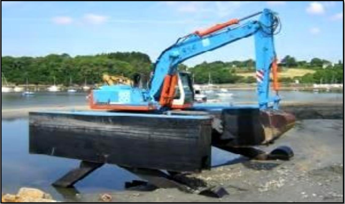
Figure IV.12. Drague mécanique amphibie (FFPP, 2005).
