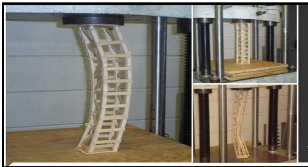
Figure I .6 : Essai de flambement d'un poteau en laboratoire
