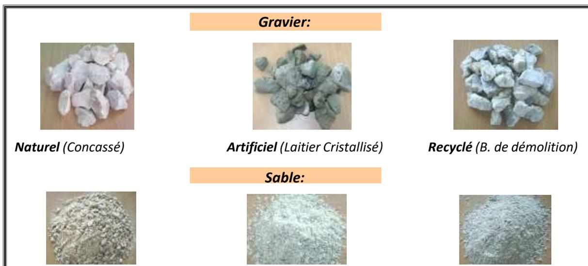
Figure I.2: Photos des différents types de granulats.
