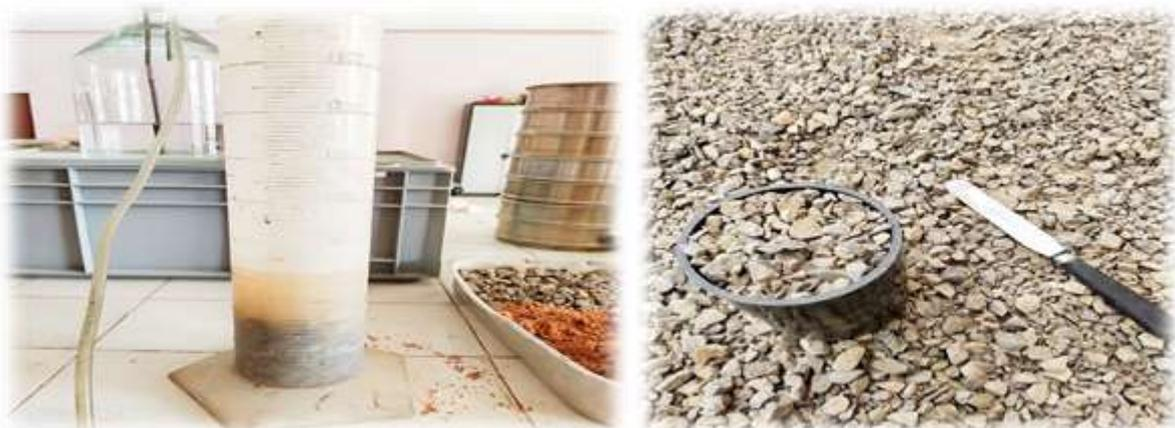
Figure III .4: essai de la masse apparent et absolue de gravier.
