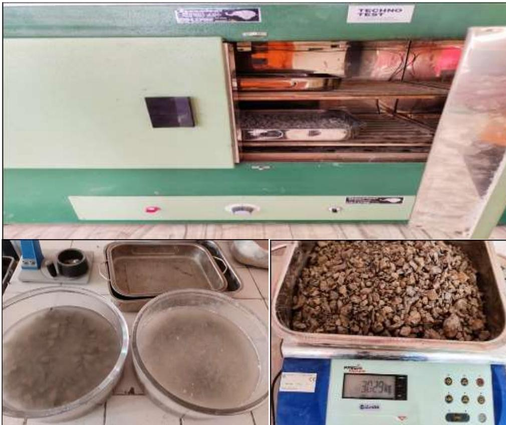
Figure III .5: Essai de coefficients d'absorptions des graviers.
