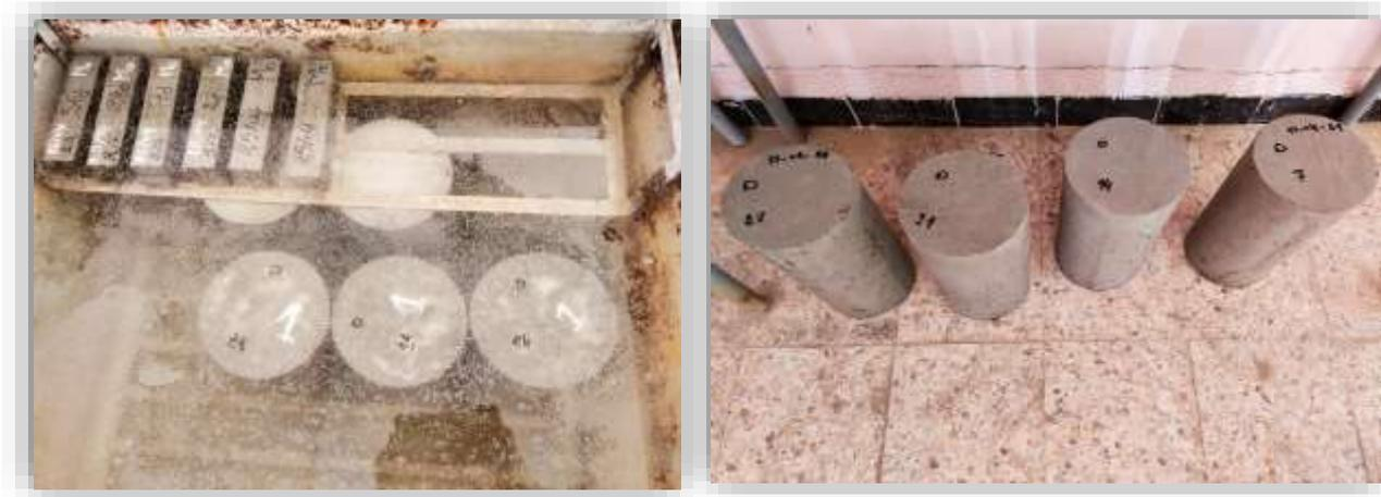
**Figure III .15:** Conservation des éprouvettes .
