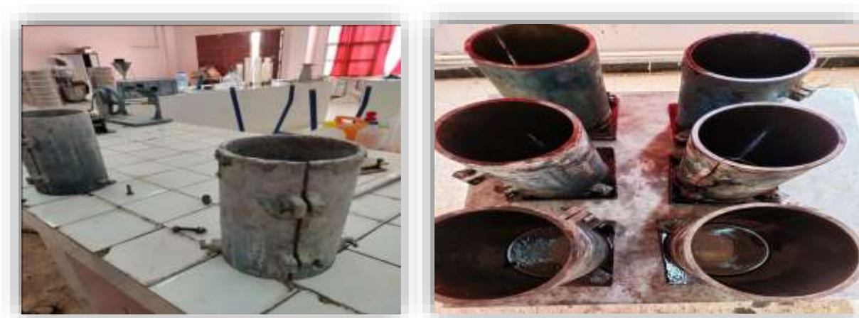
**Figure III .13:** vérification de l'état des moules.
