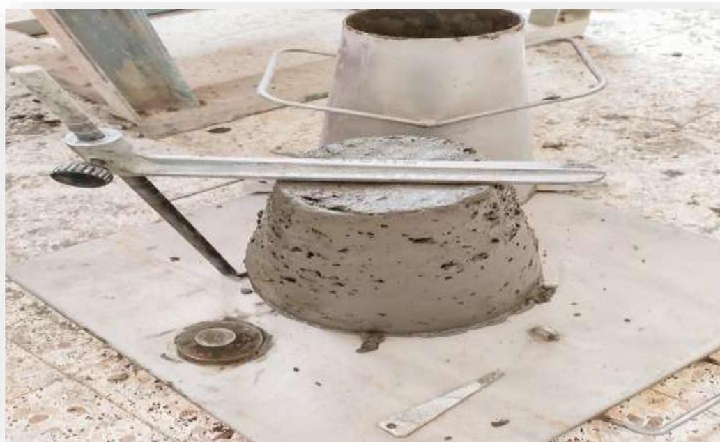
**Figure III .11:** essai de cône d'ABRAMS.
