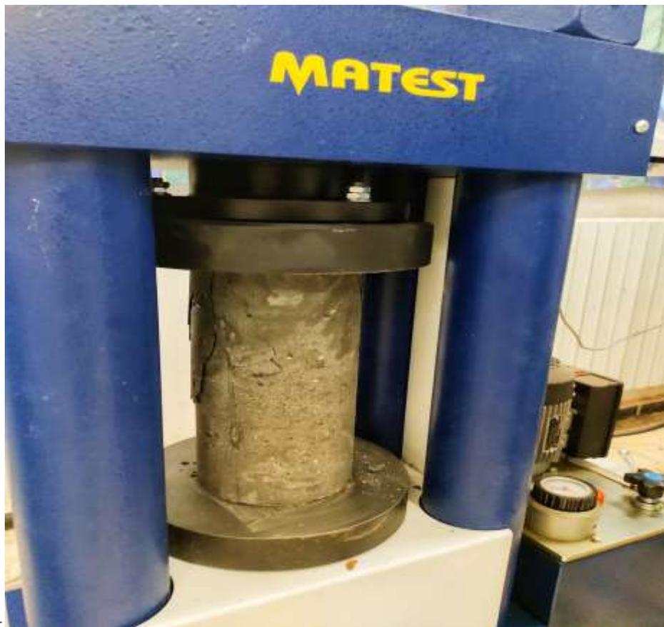
**Figure IV.1** : éprouvette en cours de l'écrasement.
