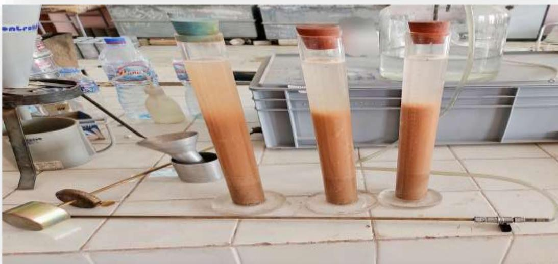
Figure III .2 : essai d'équivalent de sable.
