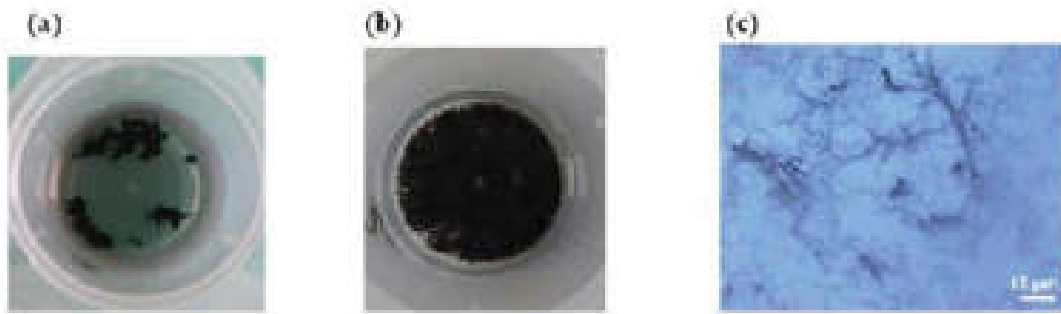
Figure II.6 L'influence de la dispersion des (CNTs) par ultrasons. (a) (CNTs) dans l'éthanol avant passage aux ultrasons. (b) Après 1 heure aux ultrasons. (c) Image microscope optique d'une gouttelette de base + (CNTs) après 2 heures de dispersion. Des agrégats sont encore présents. [Bozlar 2009]
