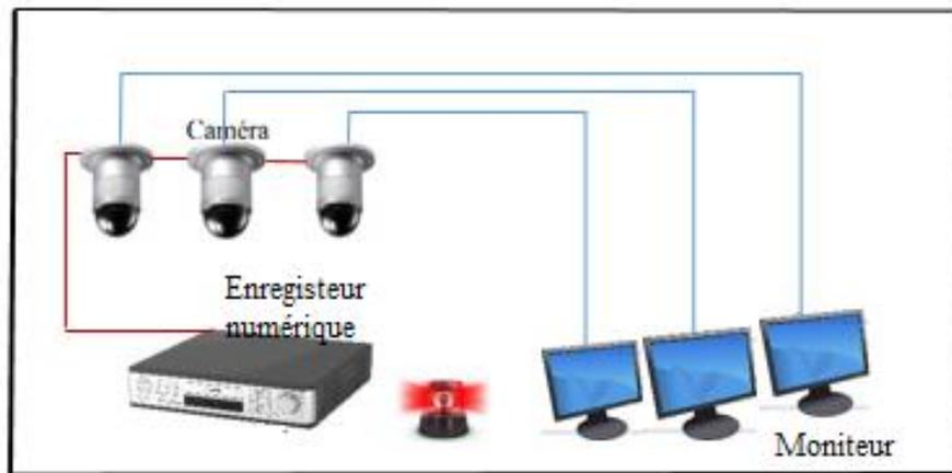
Figure 2 : Composants d'un système de vidéosurveillance simple.
